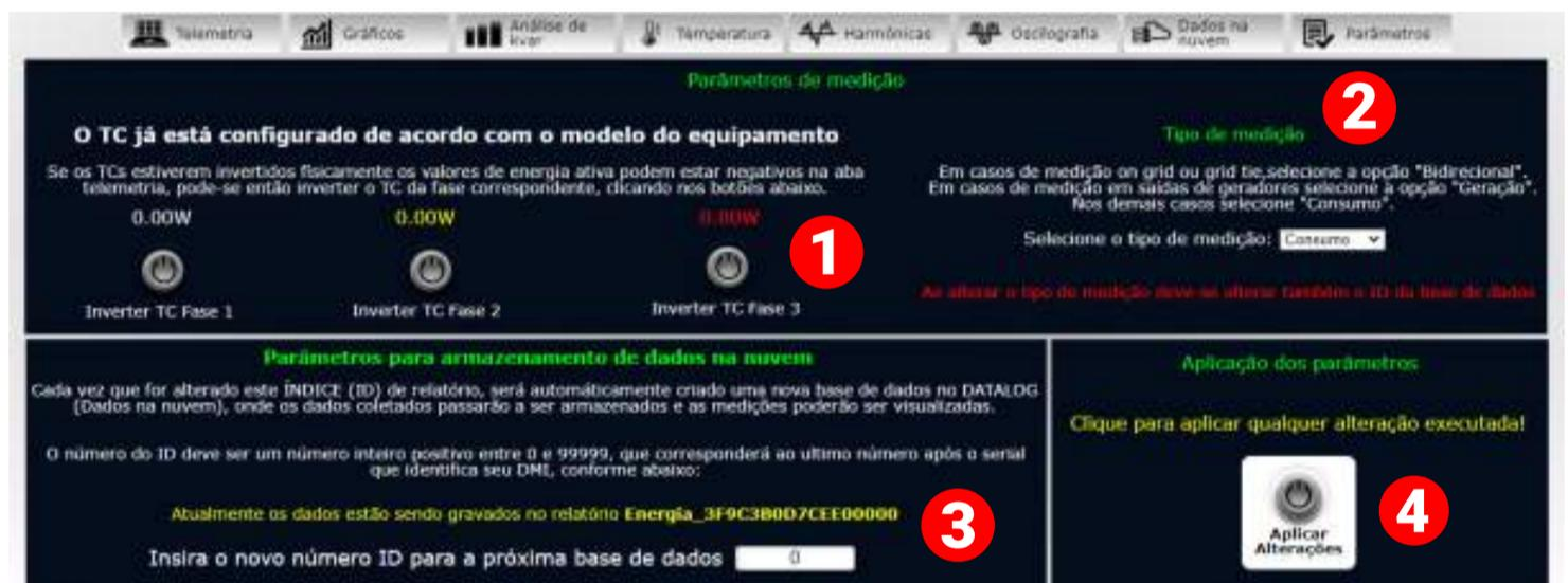
**1** Esta função **opcional** permite que você possa inverter virtualmente as bobinas se elas estiverem fisicamente instaladas voltadas para a direção incorreta (fluindo de **P2** para **P1**).
