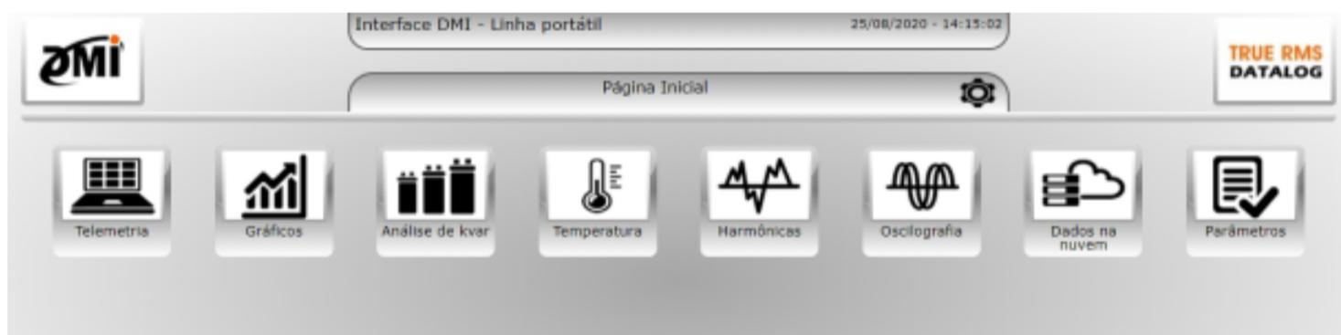
A interface web é usada para configurar seu analisador DMI, bem como para visualizar alguns dos dados coletados.
